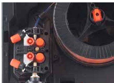
Modele Kempact 253/323 posiadają 4-rolkowy mechanizm podający DuraTorque.
